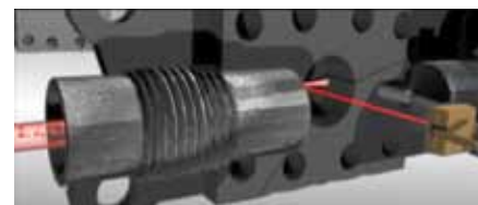
Fig. 2. När vätskan når fotodioden tänds det ytterst precisa laserljuset och projiceras genom oljepelaren. Laserdioden projicerar en avbildning av provet på en fotodiod.
