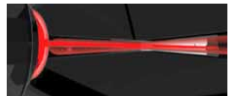
Рис. 3. Спроектированное изображение или тень, созданная загрязнением в масле, создает измеримое изменение интенсивности света.
