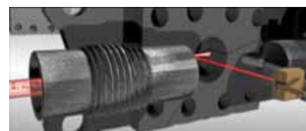
Rys. 2 Po osiągnięciu przez płyn fotodiody włączany jest przechodzący przez kolumnę oleju promień lasera o bardzo dokładnie zmierzonej energii. Dioda laserowa rzutuje obraz próbki na fotodiode.
