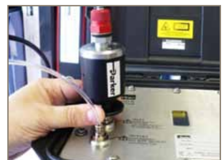
Aby zdemontować zawór PRV, należy wcisnąć narzędzie do zdejmowania i jednocześnie podnieść zawór.
