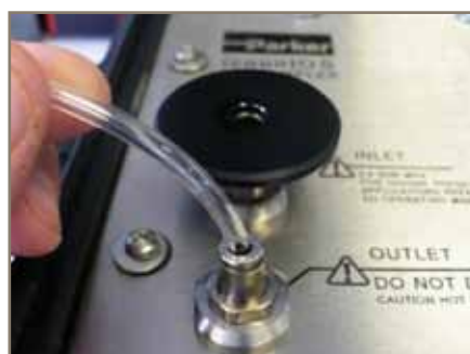
Podłączyć wężyk WYLOTOWY (Ø 4mm)
