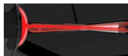
Rys. 3 Rzut, czyli cień spowodowany zanieczyszczeniami w oleju wywołuje mierzalną zmianę w intensywności światła.
