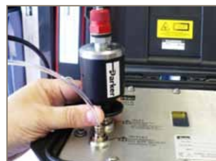
Aby zdemonstrować zawór PRV, należy wcisnąć narzędzie do zdejmowania i jednocześnie podnieść zawór.
