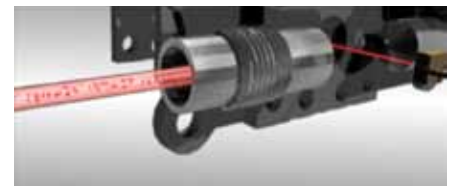
Fig. 1. In breve, un colonna controllata di fluido contaminato entra nella camera di scansione ottica laser. Questo design assicura la distribuzione della contaminazione all'interno del fluido.
