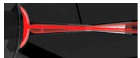
Fig. 3. L'immagine proiettata dal contaminante nell'olio comporta una variazione misurabile dell'intensità luminosa.
