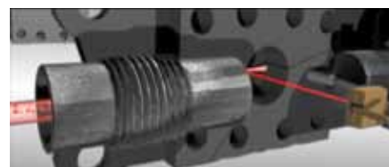
Fig 2. Lorsqu'elle atteint la cellule diode photoélectrique, la lumière laser extrêmement précise est appliquée et projetée à travers cette colonne d'huile. La diode laser projette une image de l'échantillon sur une cellule diode photoélectrique.
