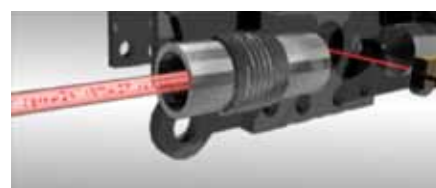
Fig. 1. Schématiquement, une colonne maîtrisée de liquide contaminé pénètre dans la chambre du scanner optique laser. Cette conception maintient la distribution de la contamination particulaire au sein du fluide.
