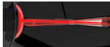
Fig 3. Une image fondue ou une ombre créée par les contaminants dans l'huile crée un changement mesurable de l'intensité de la lumière.
