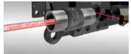
Kuva 1. Hallittu patsas kontaminoitunutta nestettä saapuu laser-optiseen skannauskammioon. Rakenteen ansiosta kontaminaation jakauma nesteessä säilyy.
