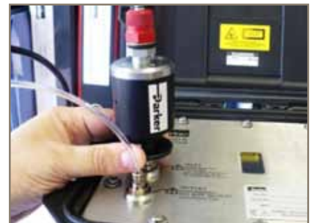
PRV irrotetaan painamalla irrotus- tustyökalua alaspäin samalla, kun PRV nostetaan irti.
