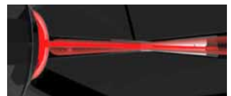
Fig 3. Una imagen o sombra creada por el contaminante del aceite produce una variación medible de la intensidad de la luz.
