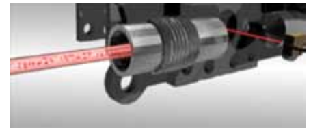
Fig 1. En términos simples, una columna controlada del fluido contaminado entra a la cámara del escáner óptico láser. Este diseño mantiene la distribución de la contaminación en el líquido.
