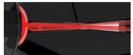
Abb. 3: Der von den Verschmutzungen im Fluid verursachte Schatten wird als messbare Veränderung der Lichtstärke ausgewertet.
