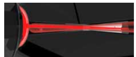
图3. 油污染造成的投影或阴影引起可衡量的光强度变化。
