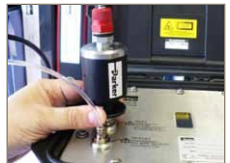
要拆除PRV时，可按下拆除工具并同时提升PRV，以便将其拆除。
