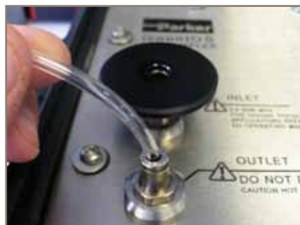
连接高压软管至OUTLET口 (Ø4毫米)
